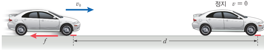
그림 I-59 자동차의 제동 거리
