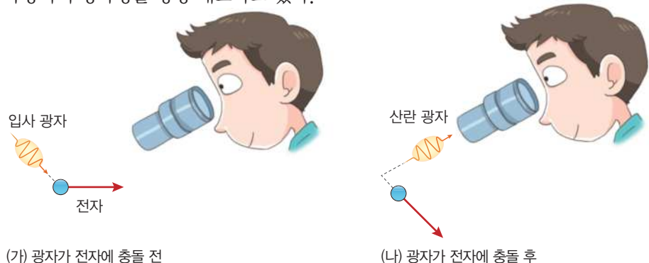
그림 III-60 전자의 위치 측정과 운동량의 변화
