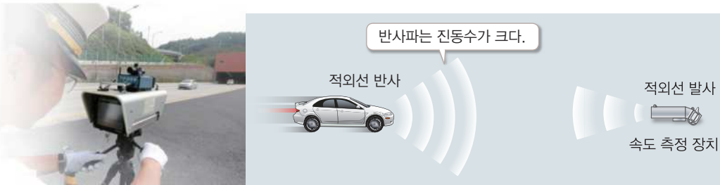
그림 III-18 속도 측정 장치와 원리 | 속력이 빠른 차량일수록 반사되는 적외선의 진동수가 크다.
