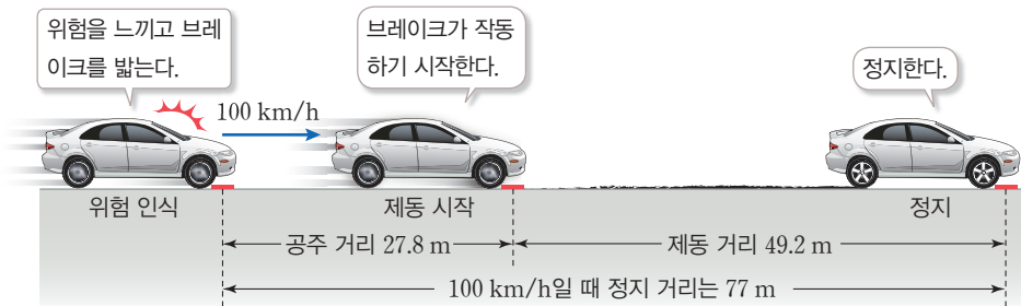
그림 I-60 자동차의 정지 거리
