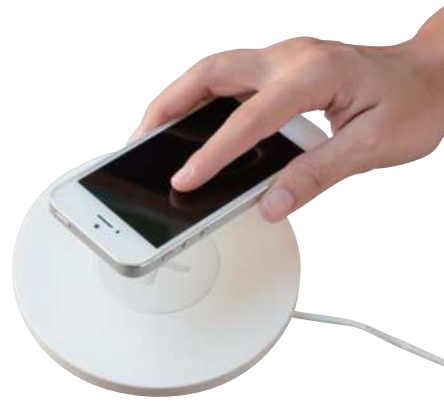
그림 II-55 스마트폰 무선 충전기
